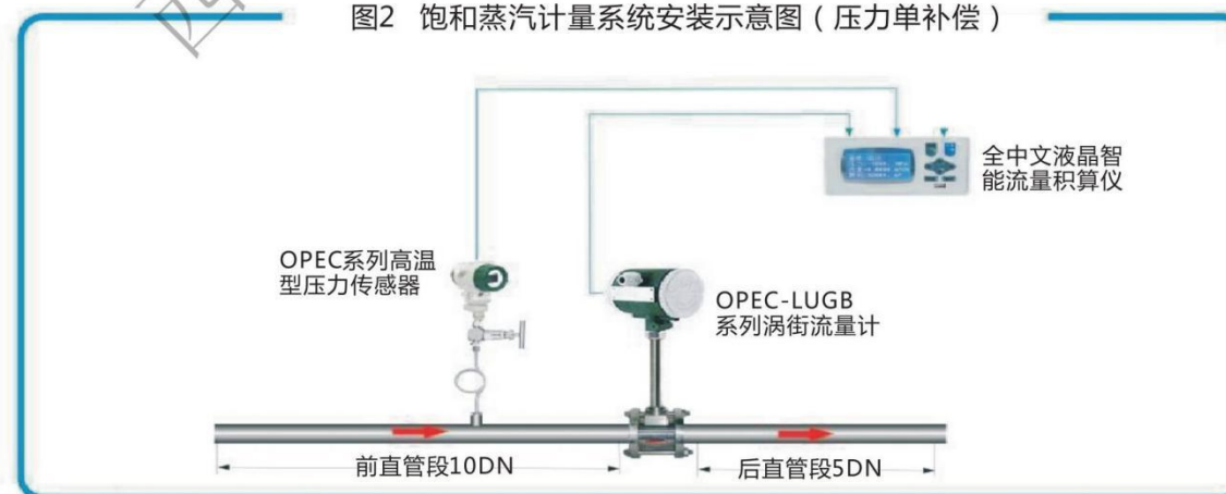
图2 饱和蒸汽计量系统安装示意图（压力单补偿）
