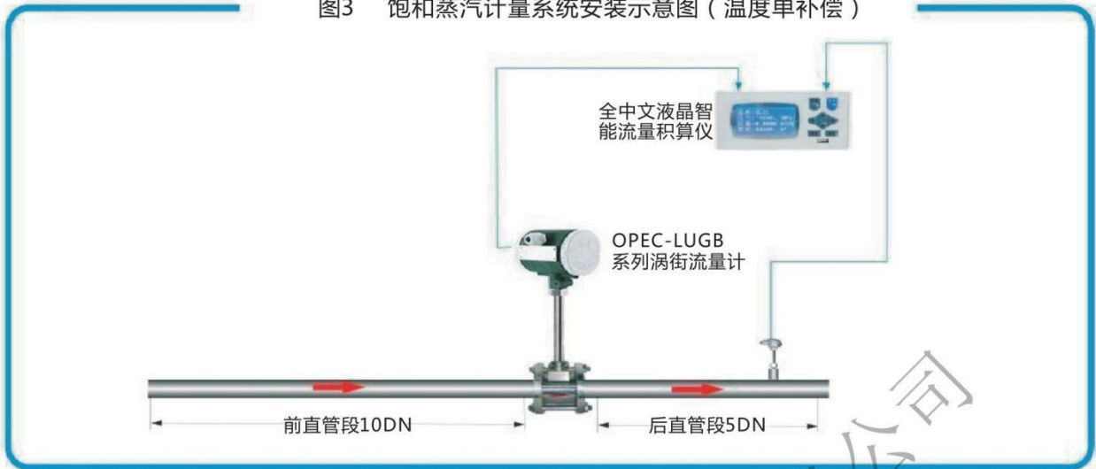
图3 饱和蒸汽计量系统安装示意图（温度单补偿）
